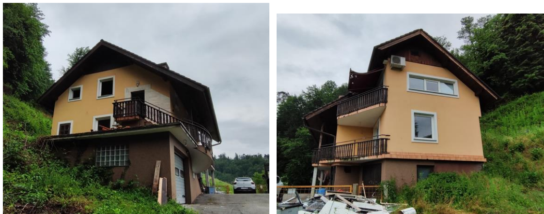
Slika 4: Prikaz asimetrične dvokapnice obstoječega objekta, ki ni skladna z določil PIA . Objekt bo odstranjen.
